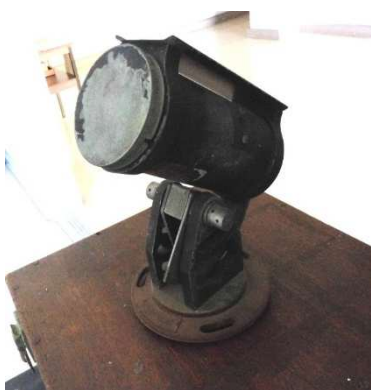
写真4.9 ジョルダン日照計 「名古屋気象台 100周年記念特設サイト」から
