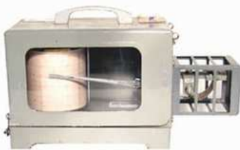
写真 2.3 バイメタル式自記温度計 (太田計器製作所製)
