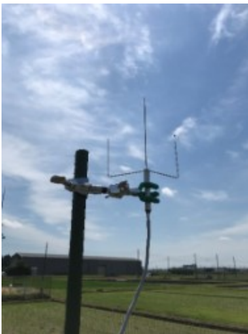
写真 三球温度計の設置例
