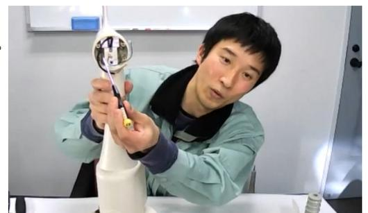
写真1 風車型風向風速計を分解して、回路などを説明
