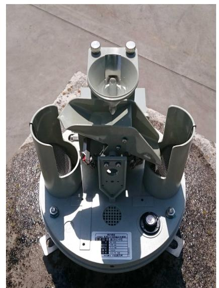
写真2 転倒ます型雨量計感部
