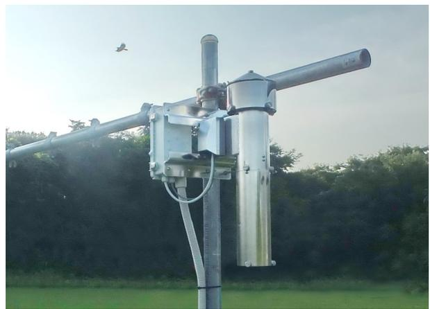
写真② AMeDAS に採用された強制通風筒
