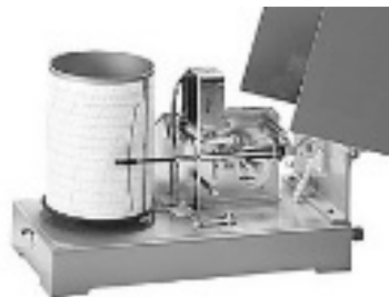
図 4-1 自記電接計数器
