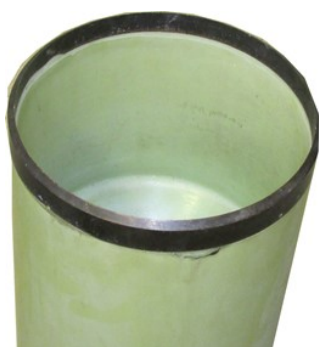
図 2-13 受水口上部のナイフエッジ
