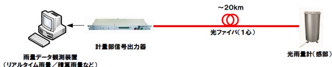
図 3-13 システム構成（古河電工のホームページより）
