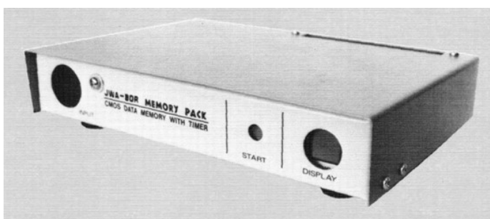
図 4-2 データロガー JWA-80R 1981 年 (東洋電子工業の社内資料より)
