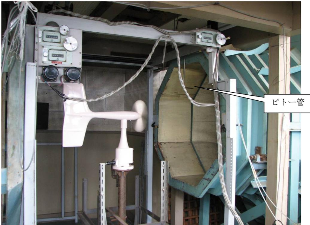
写真-1 風洞実験中のプロペラ型風向風速計
